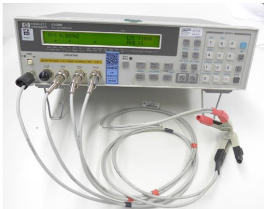
Bild / pic 1: Milliohm-meter / Milliohm-meter
