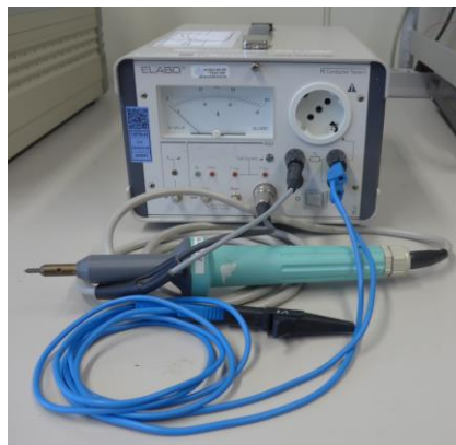
Bild / pic 2: Elabo Schutzleitermessgerät / Protective earth measuring device
